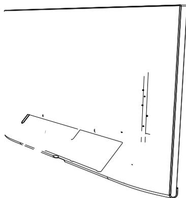
Le capot latéral du TV s'ouvre et se ferme aisément mais il peut être entièrement retiré. Pour ce faire, ouvrez-le jusqu'à la butée et tirez sans trop forcer sur le couvercle ouvert.
